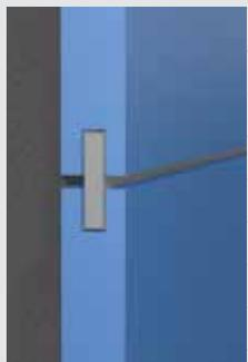
Наклонное соединение подходит для облицовки стен (силосы, стены), где происходит непрерывное одностороннее скольжение материала.
